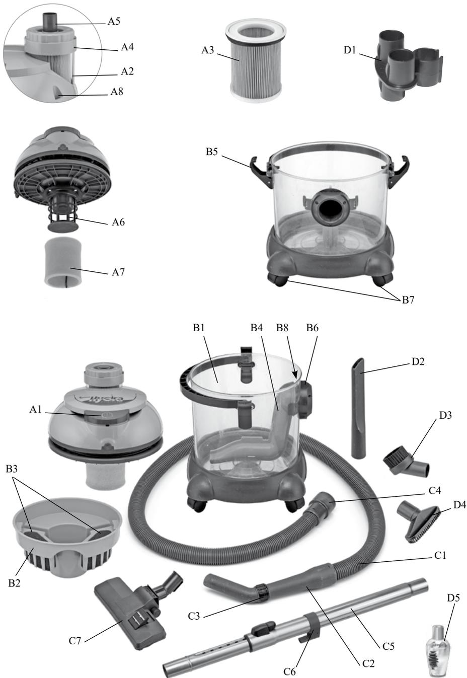
**A. Zespół silnikowy.** Ta sekcja obejmuje silnik, wyłącznik oraz elementy robocze. Górną część tej sekcji stanowi filtr HEPA służący do odfiltrowania kurzu oraz innych drobnych cząstek z wydmuchiwanego powietrza. Pod filtrem piankowym umieszczony jest duży, plastikowy pływak który w miarę napełniania się pojemnika unosi się i odcina podciśnienie, tym samym ostrzegając o konieczności opróżnienia pojemnika
